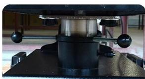
**Facile regolazione della pressione:** Puoi regolare facilmente le impostazioni della pressione prima, durante o dopo il lavoro di trasferimento del calore con la manopola rotante.
