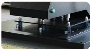
**Pressione di contatto verticale:** La testa pneumatica della piastra riscaldante fornisce una pressione di contatto verticale, facilitando il trasferimento impeccabile di vari materiali senza effetti di spostamento.
