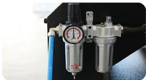
**Filtro dell'aria:** Per regolare la pressione della pressa di calore APHD di grandi dimensioni, facile da usare e da mantenere.
