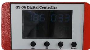
**Controllore digitale GY-06:** Dotato di controller digitale GY-06 che consente di impostare e regolare sia la temperatura che il tempo di pressatura. Questo controllo preciso è essenziale per ottenere i migliori risultati con diversi tipi di materiali e trasferimenti.
