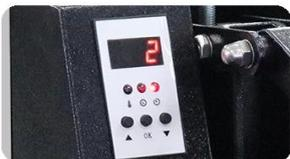
**Contrôleur numérique GY-04N :** Forme verticale du contrôleur pour afficher l'heure et la température précises.
