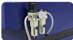
**Filtre à air:** Pour en ajuster la pression, facile à utiliser et à entretenir.
