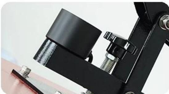
Ouverture automatique : cette presse à chaud à ouverture automatique utilise un mécanisme de libération d'électroaimant avec un ressort à gaz.
