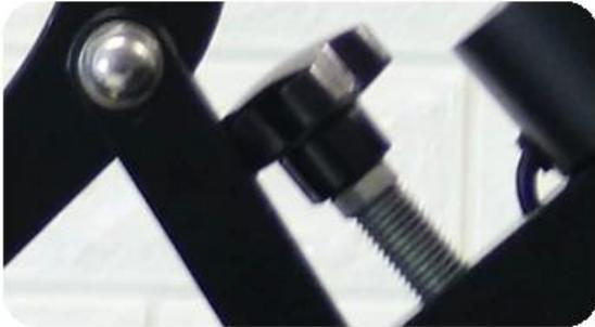
Bouton de réglage de la pression : pour régler facilement la pression lors de la sublimation d'articles d'épaisseurs différentes.
