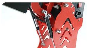
**Ressort à gaz de haute qualité** : Ce ressort à gaz permet à la presse à chaud pour ballons de sport de s'ouvrir en douceur et en toute sécurité.
