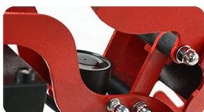
**Libération à ouverture automatique** : S'ouvre automatiquement une fois le temps réglé écoulé, avec un grand angle d'ouverture.
