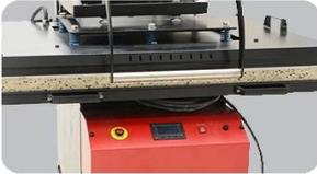
**Plaque de base débrochable :** Avec une poignée plus solide, l'opérateur peut retirer la base sans aucune difficulté.
