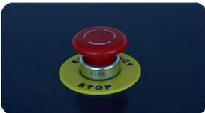
**Interrupteur d'arrêt d'urgence :** En cas d'urgence, l'opérateur peut appuyer sur cet interrupteur pour arrêter l'opération.
