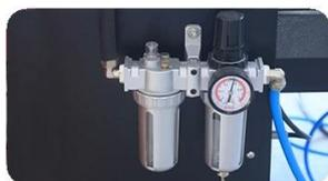
**Pression réglable :** Vous pouvez facilement ajuster les paramètres de pression pour s'adapter à différents matériaux et épaisseurs, garantissant ainsi que le transfert de chaleur adhère correctement sans endommager le tissu ou le substrat.
