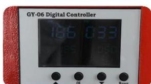
**Contrôleur d'écran tactile GY-06 :** Équipé d'un panneau de commande numérique qui vous permet de régler et d'ajuster la température et l'heure. Ce contrôle précis est essentiel pour obtenir les meilleurs résultats avec différents matériaux et transferts.
