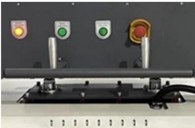
**Commande à deux mains de sécurité :** cette commande bimanuelle assure une sécurité accrue en nécessitant l'activation simultanée des boutons avec les deux mains. Empêche le fonctionnement accidentel, protège l'opérateur contre les blessures potentielles.
