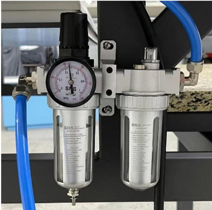
**Système de filtre à air :** le système de filtre à air intégré améliore la qualité de l'air, protège les machines, réduit la contamination, améliore la sécurité et facilite la maintenance.
