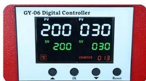
**Contrôleur numérique GY-06 :** Ce contrôleur affichera directement l'heure et la température de réglage et l'heure et la température actuelles en même temps.
