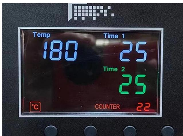
**CY-08 Heure et température numériques. Contrôle:** Le panneau de commande numérique convivial permet des réglages précis du temps, de la température et de la pression, vous permettant de personnaliser le processus de transfert de chaleur en fonction de différents matériaux.
