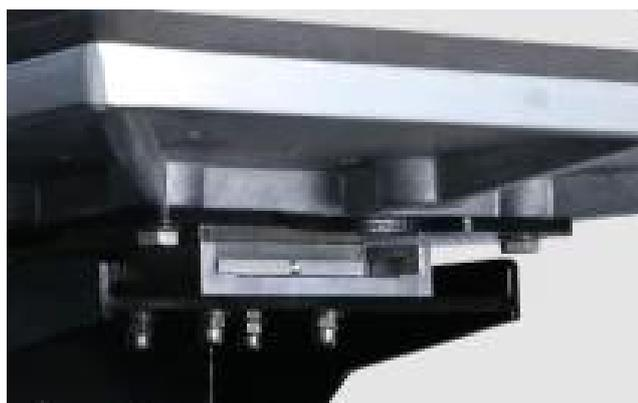
**Deux plateaux inférieurs à changement rapide :** La fonction des plateaux inférieurs permet un échange rapide et sans effort des plaques inférieures sur la presse à chaud. Cette conception innovante rationalise le processus, réduisant les temps d'arrêt et améliorant la productivité.
