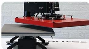
**Conception pivotante** : La conception spéciale pivotante offre un accès totalement dégagé au plateau inférieur, permettant un chargement facile des vêtements et le placement des transferts.
