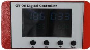
**Contrôleur numérique GY-06 :** Équipé d'un panneau de commande numérique qui vous permet de régler et d'ajuster la température et l'heure. Ce contrôle précis est essentiel pour obtenir les meilleurs résultats avec différents matériaux et transferts.
