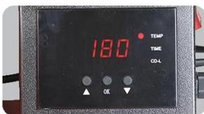
**Contrôleur numérique GY-04 :** Ce contrôleur est très simple pour régler l'heure et la température. Plus précis de l'heure et de la température. afficher.
