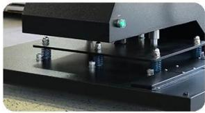
**Pression de contact verticale :** La tête pneumatique de la plaque chauffante fournit une pression de contact verticale, facilitant un transfert parfait de divers matériaux sans effets de déplacement.
