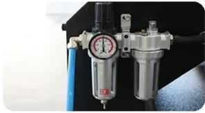
**Filtre à air:** Pour ajuster la pression de la grande presse à chaud APHD, facile à utiliser et à entretenir.
