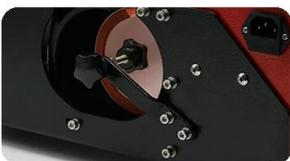
**Bloque de soporte:** Puede aumentar la presión de transferencia de la prensa de tazas y evitar que la taza se mueva después de un uso prolongado.
