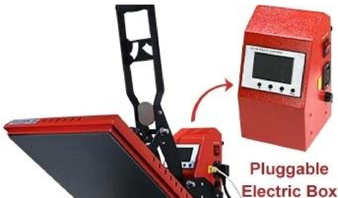
Caja de control desmontable: este diseño simplifica la resolución de problemas y minimiza el tiempo de inactividad, lo que permite reparaciones rápidas y específicas.
