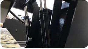
**Resorte de gas fuerte:** Con 4 resortes de gas de 135 kg, la máquina funciona con una presión uniforme y mantiene el resultado de la transferencia de manera constante.
