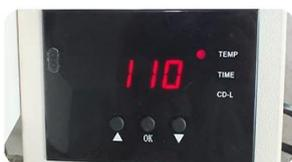
El controlador digital GY-04 ofrece controles y pantallas digitales completos y permite operaciones y configuraciones simples para la prensa de sublimación de gran formato.
