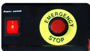
**Interruptor de parada de emergencia:** Con el interruptor de emergencia es posible prevenir accidentes y errores durante el funcionamiento de la prensa térmica automática abierta de gran formato.
