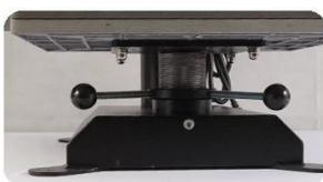
**Control de presión ajustable:** La serie SA-15/20 presenta un control de presión fácil de ajustar, lo que permite a los usuarios personalizar la presión según los requisitos de los diferentes sustratos.
