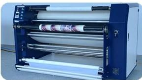
**Diseño rollo a rollo:**Transferencia de calor de rollo a rollo que aumenta la eficiencia de la transferencia
