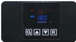
**Controlador digital de pantalla táctil GY-10:** Este controlador hace que la prensa térmica luzca más moderna; Le resultará fácil configurar la hora y la temperatura. Más preciso de la hora y la temperatura. mostrar
