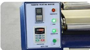
**Controlador digital:** Control de temperatura separado y control de velocidad de transformación; Es fácil para usted configurar el tiempo, la temperatura y la velocidad. Más preciso de la hora y la temperatura. monitor
