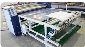
**Máquina con mesa de mantas:**No se necesita máquina de enfriamiento y la manta se puede separar del tanque de aceite. Fácil de hacer rollo a rollo o pieza cortada
