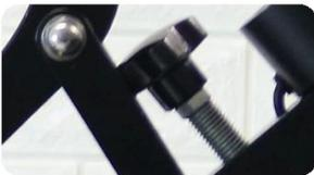
**Perilla de ajuste de presión:** Para ajustar la presión fácilmente al sublimar prendas de diferentes espesores.
