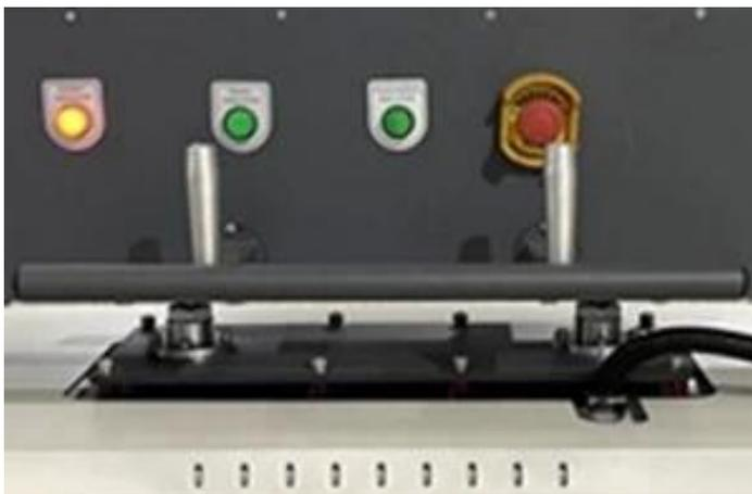
**Control de seguridad a dos manos:** Este control de dos manos garantiza una mayor seguridad al requerir la activación simultánea de botones con ambas manos. Previene la operación accidental, protege al operador de posibles lesiones.
