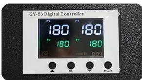
**Controlador digital avanzado GY-06:** Diseño simple y sistema claro. Es muy fácil de operar para el usuario. Lectura digital en vivo de hora y temperatura para obtener resultados precisos en todo momento.
