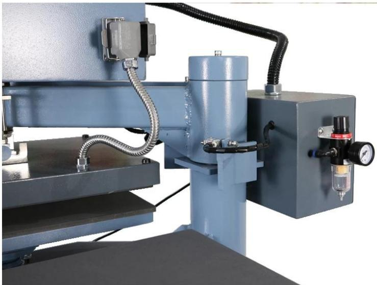
**Eficiencia de doble mesa:** Equipado con una función de mesa doble, que permite a los operadores preparar el siguiente artículo para prensar mientras la primera mesa está en uso, optimizando el flujo de trabajo en entornos de producción de gran volumen.
