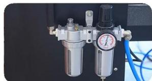
**Presión ajustable:** Puede ajustar fácilmente los ajustes de presión para adaptarse a diversos materiales y espesores, asegurando que la transferencia de calor se adhiera correctamente sin dañar la tela o el sustrato.
