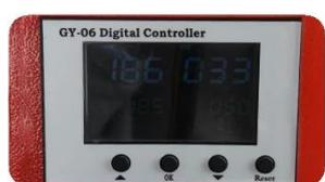
**Controlador digital GY-06:** Equipado con un panel de control digital que permite configurar y ajustar tanto la temperatura como el tiempo. Este control preciso es esencial para lograr los mejores resultados con diferentes materiales y transfers.
