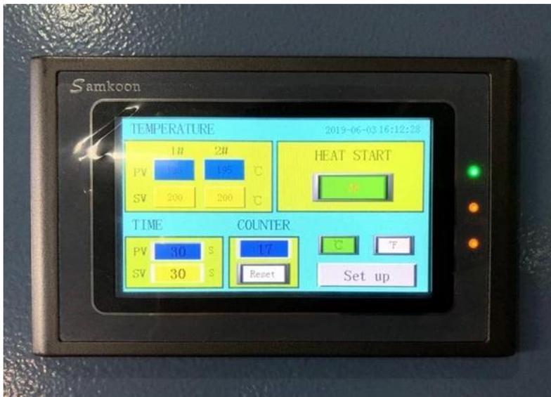
**Control digital de pantalla táctil PLC:** El panel de control digital fácil de usar permite ajustes precisos de tiempo, temperatura y presión, lo que le permite personalizar el proceso de transferencia de calor para adaptarse a diferentes materiales.
