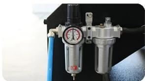
**Filtro de aire:** Para ajustar la presión de la máquina de prensado en caliente grande APHD, fácil de operar y mantener.
