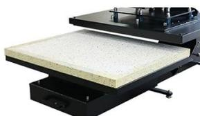
**Placa inferior deslizable:** El diseño de la placa inferior deslizable mejora la comodidad para la colocación del material y garantiza la seguridad contra el calor durante la operación.
