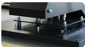
**Presión de contacto vertical:** El cabezal neumático de la placa calefactora proporciona una presión de contacto vertical, lo que facilita la transferencia perfecta de diversos materiales sin efectos de desplazamiento.
