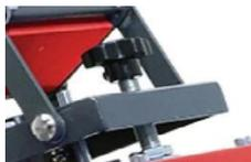
**Perilla de ajuste de presión:** Para ajustar fácilmente la presión al sublimar prendas de diferentes grosores.
