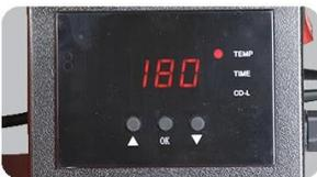
**GY-04 Digitaler Regler:** Einfaches Design und klares System. Die Bedienung ist für den Benutzer sehr einfach. Digitale Live-Zeit- und Temperaturanzeige für jederzeit genaue Ergebnisse.
