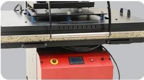
**Ausziehbare Grundplatte:** Mit dem stärkeren Griff kann der Bediener den Unterboden problemlos herausziehen.
