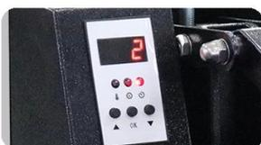
**Digitaler Regler GY-04N:** Ausgestattet mit einer digitalen Steuerung GY-04N gewährleistet diese manuelle Transferpresse einen einfachen und effizienten Betrieb.
