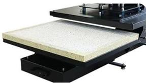
**Ausziehbare Unterplatte:** Das herausziehbare Design der Unterplatte erleichtert die Materialplatzierung und sorgt für Schutz vor Hitze während des Betriebs.
