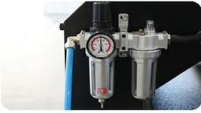
**Luftfilter:** Zum Einstellen des Drucks der großen APHD-Heißpressmaschine, einfach zu bedienen und zu warten.
