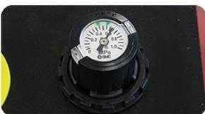
**Druckeinstellung:** Die Druckeinstellvorrichtung ist auf dem Bedienfeld installiert, und der Druck kann durch Hochziehen und Drehen des Knopfes eingestellt werden.
