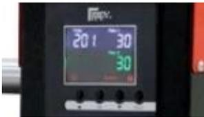
**Digitaler Regler GY-08:** Ausgestattet mit einem digitalen Bedienfeld, mit dem Sie sowohl die Temperatur als auch die Presszeit einstellen und anpassen können. Diese präzise Kontrolle ist unerlässlich, um bei unterschiedlichen Materialarten und Transfers die besten Ergebnisse zu erzielen.
