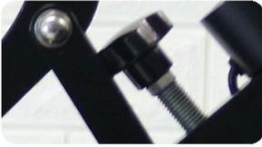
**Einfache Druckeinstellung:** Ein Drehknopf ermöglicht einfache Anpassungen der Druckeinstellung vor, während oder nach dem Heißpressvorgang und bietet so Flexibilität und Kontrolle.
