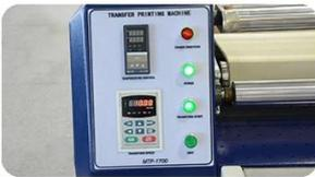
**Digitaler Controller:** Separate Temperaturregelung und transformieren Geschwindigkeitsregelung; Sie können ganz einfach Zeit, Temperatur und Geschwindigkeit einstellen. Genauere Zeit und Temp. Anzeige
