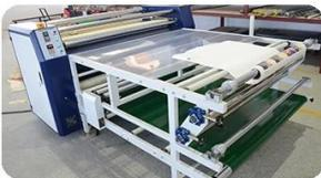
**Maschine mit Deckentisch:** Es wird keine Kühlmaschine benötigt und die Decke kann vom Öltank getrennt werden. Einfach Rolle-zu-Rolle oder Zuschnitt
