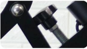
**Einfache Druckeinstellung:** Ein Drehknopf ermöglicht einfache Anpassungen der Druckeinstellung vor, während oder nach dem Heißpressvorgang und bietet so Flexibilität und Kontrolle.
