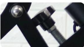
**Druckeinstellknopf:** Zum einfachen Anpassen des Drucks beim Sublimieren von Gegenständen mit unterschiedlichen Dicken.
