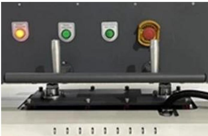
**Sicherheits-Zweihandsteuerung:** Diese Zweihandsteuerung sorgt für mehr Sicherheit, da die Tasten gleichzeitig mit beiden Händen betätigt werden müssen. Verhindert versehentliche Betätigung und schützt den Bediener vor möglichen Verletzungen.
