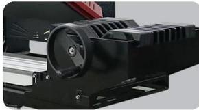
**Zuführgerät:** Rolle-zu-Rolle-Zuführungsband, einfach zu bedienen und hilft dabei, das Band gleichmäßig zu platzieren, um einen besseren Übertragungseffekt zu erzielen;
