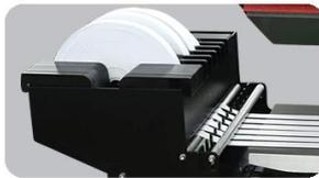
**Einstellbare Rollenbreite:** Die Breite der Rolle kann angepasst werden, so dass sie für Lanyards mit einer Breite von 12/20/25 mm verwendet werden kann.
