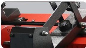
**Magnetische automatische Öffnungsfreigabe:** Die automatische Öffnungsfunktion ermöglicht das automatische Öffnen der Transferpresse, während die Sublimationswärmeübertragung abgeschlossen ist.
