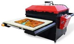
**Doppelarbeitsplatz:** Mit zwei separaten Stationen, die das gleichzeitige Drucken auf zwei verschiedenen Artikeln oder Standorten ermöglichen. Diese Funktion erhöht die Produktivität erheblich.
