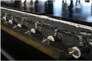
**Einzelne steckbare Wärmerohre:** Verwendet eine feine Aluminium-Heizplatte mit einzelnen einsteckbaren Heizrohren für gleichmäßige Wärmeverteilung und einfache Wartung, da Sie defekte Heizrohre einzeln austauschen können, was Ausfallzeiten und Kosten reduziert.
