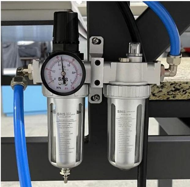
**Luftfiltersystem:** Das integrierte Luftfiltersystem sorgt für eine verbesserte Luftqualität, Schutz der Maschinen, Reduzierung von Verunreinigungen, erhöhte Sicherheit und einfache Wartung.
