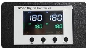
**Aktualisieren Sie den digitalen Regler GY-06.** Dieser digitale Controller zeigt direkt die eingestellte Zeit, Temperatur und den Zähler sowie die aktuelle Zeit und Temperatur gleichzeitig an.
