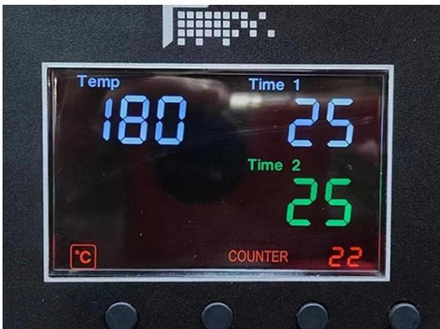
**GY-08 Digitale Zeit und Temperatur. Kontrolle:** Das benutzerfreundliche digitale Bedienfeld ermöglicht eine präzise Anpassung der Zeit-, Temperatur- und Druckeinstellungen, sodass Sie den Wärmeübertragungsprozess an verschiedene Materialien anpassen können.
