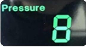
**Drucksensorgerät:** Mit einem High-End-Drucksensor kann der Druck angezeigt werden, sodass der richtige Druck je nach Transfermaterial gewährleistet ist.
