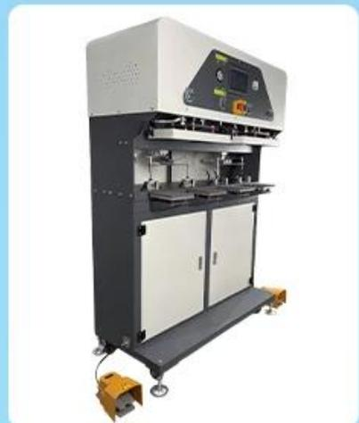
E4 ist eine vollautomatische pneumatische Etikettiermaschine, die die neueste Touchscreen-SPS-Steuerung von Microtec für eine präzisere Temperaturregelung verwendet. 4 Arbeitsstationen zur Verbesserung der Effizienz, 2 Startmodi (Start per Hand oder Fußschalter). Verwenden Sie das
